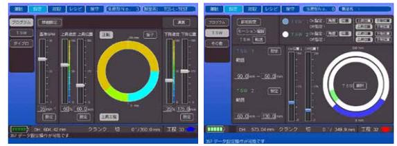
クランクシャフトの回転動作をイメージしたドーナツ形状のタッチ入力方式。直感的な操作でプレスモーションとタイミングスイッチの設定が可能です。
