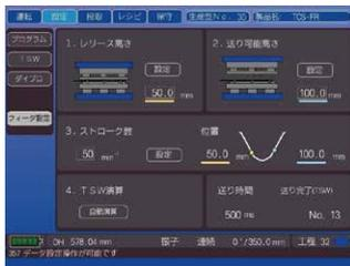
アイダのFA(自動化)装置との組合せにより、送り条件等の簡単な設定をするだけで、振り子ストローク長さを自動演算できます。
