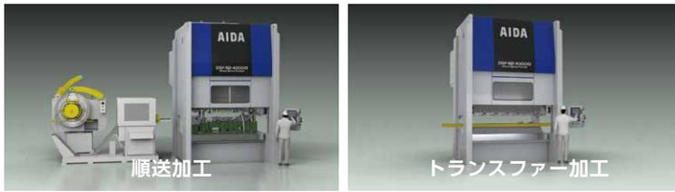
新設計の一体型フレームの採用により、動的精度と剛性が向上しました。フレームの伸びがほぼ前後左右均一になるシンメトリックなフレーム構造で動的精度が向上しました。順送加工、トランスファー加工などで高精度な加工を実現します。
