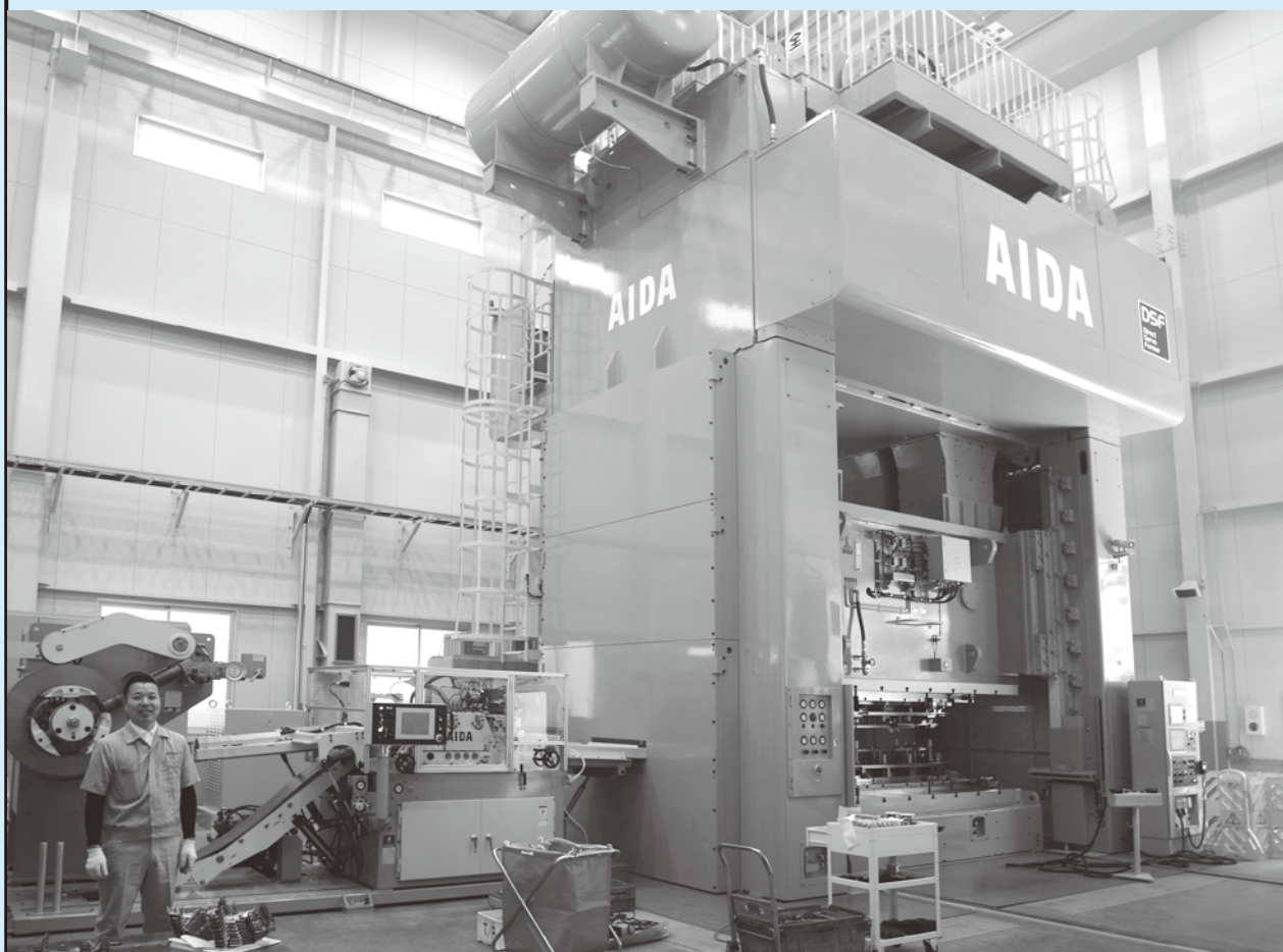
▲ ダイレクトサーボフォーマー DSF-S4-13000(1300トン)プレス+レベラーフィーダー-LFG-800E-3C
