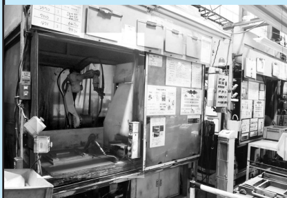
▲ ロボット溶接
