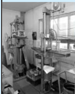
▲ 製品検査室には硬度試験機、回転摩耗試験機、画像測定器、投影機、三次元測定機を配置している
