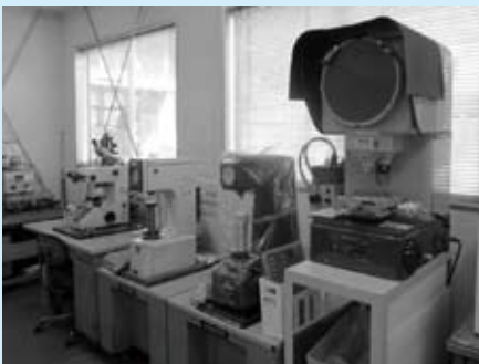
▲ 製品検査室には硬度試験機、回転摩耗試験機、画像測定器、投影機、三次元測定機を配置している
