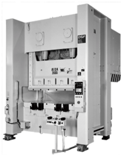
▲ 2023年5月より稼働するサーボプレスDSF-N2-2000(200トン)、DSF-C1-1500A2(150トン)
