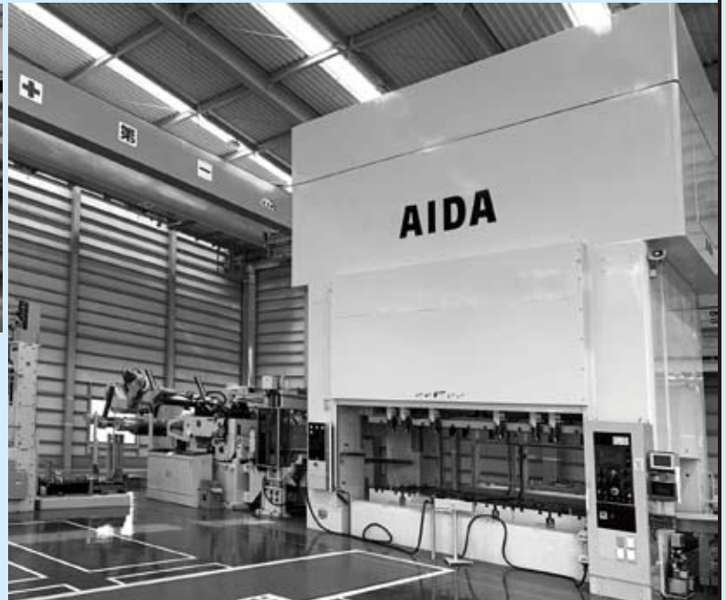
▲ 第三工場に設置した PMX-1200 トンプレス
