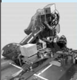
▲ 溶接ロボット
