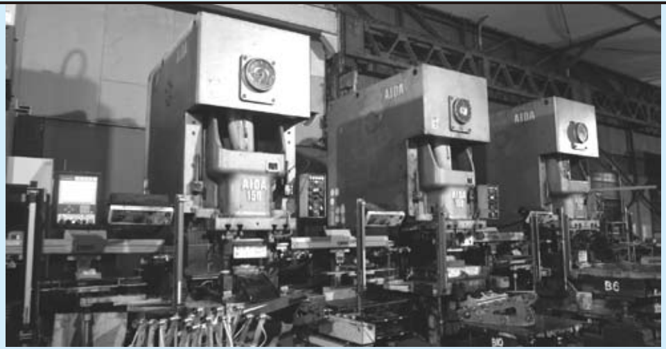
▲ NC1-150トンロボットライン
