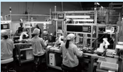
▲人と協働ロボットによる組立ライン
