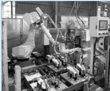
▲ 溶接ロボット
