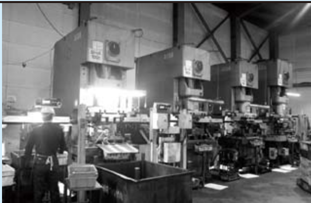
▲ NC1-150トン3台+200トン1台編成のロボットライン
