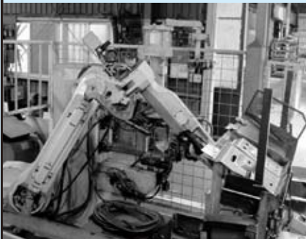
▲ 溶接ロボット
