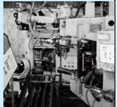
▲ 溶接ロボット
