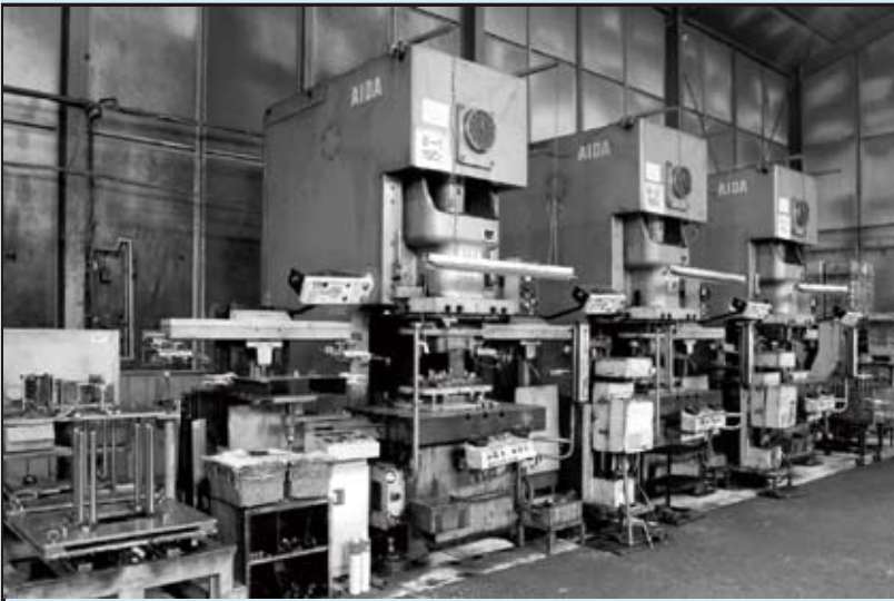
▲ NC1-150トン3台自動化ライン
