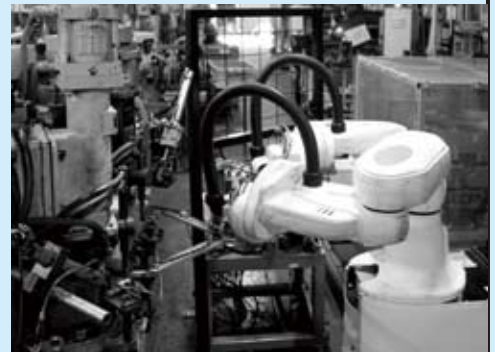
▲ 双腕溶接ロボット
