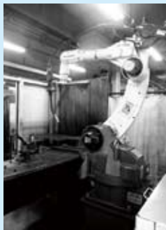
▲ 溶接ロボット
