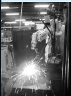
▲ 溶接ロボット
