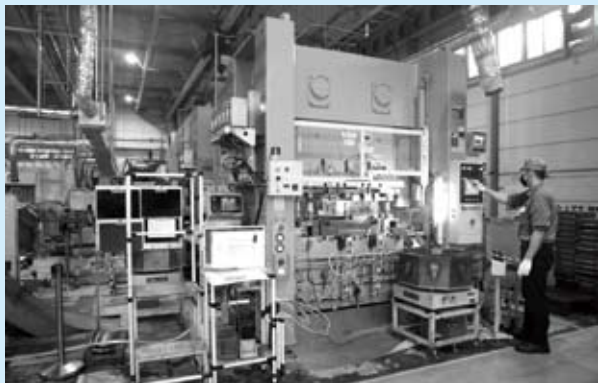
▲ ダイレクトサーボフォーマー DSF-N2-2000(200トン)3台ライン
