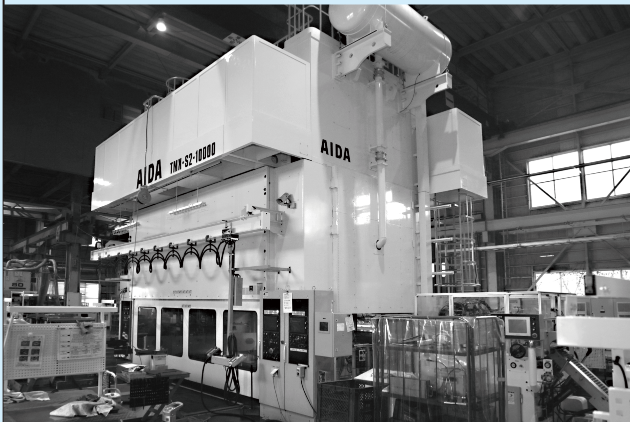
▲ TMX-S2-10000(1000トン)トランスファー、順送併用プレス
