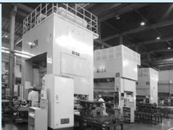
▲ SMX-400トン、300トン、200トンタンデムライン
