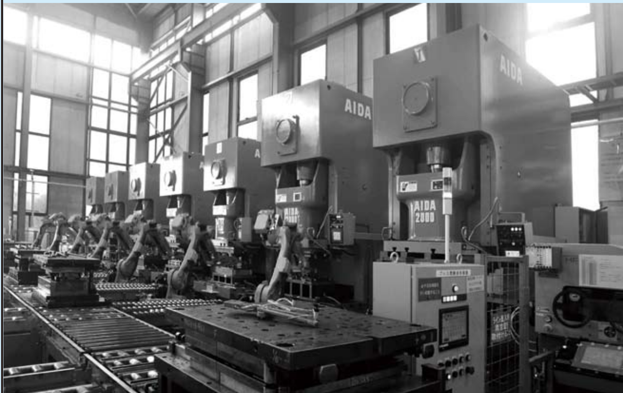
▲ NC1-200トンから150トン7台ロボットライン
