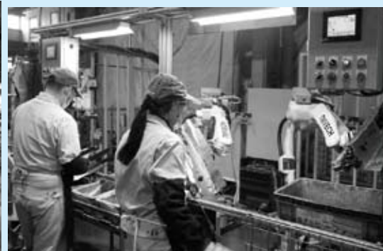
▲ ロボット溶接
