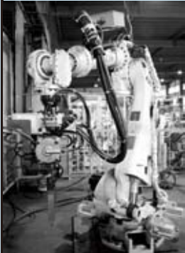
▲ 大型溶接ロボット
