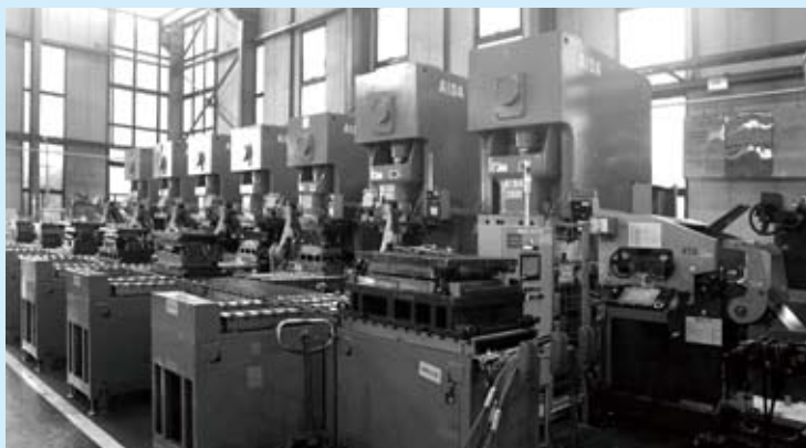
▲プレス間を多軸ロボットで搬送させた無人化プレス7台ロボットライン
