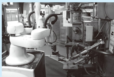
▲ スポット溶接工程での双腕協働ロボット
