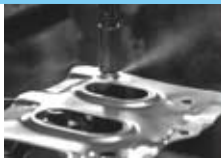
▲スポット溶接
