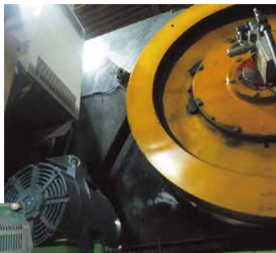
インバータモータ : 30kW
