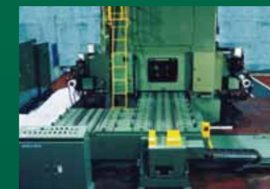
中小型機は、金型交換台車 (2面式) 追設。
