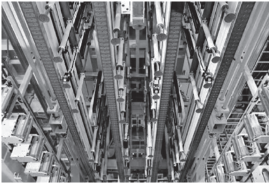
写真7 高速ハイブリッドコンベヤ
