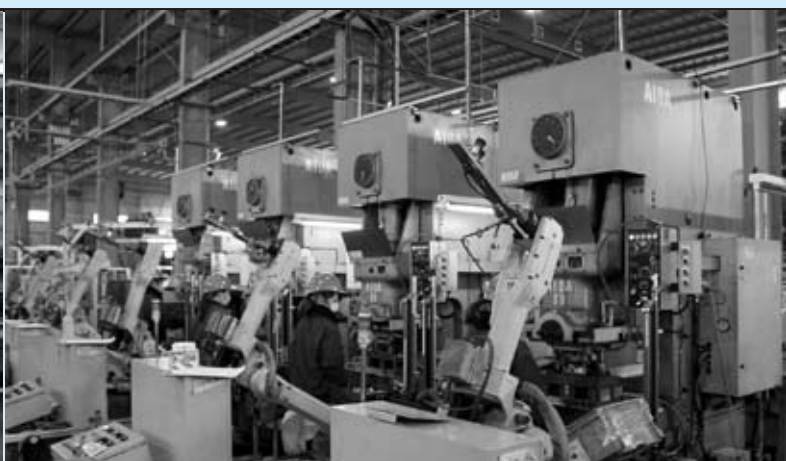
▲ NC1-80トンロボットライン
