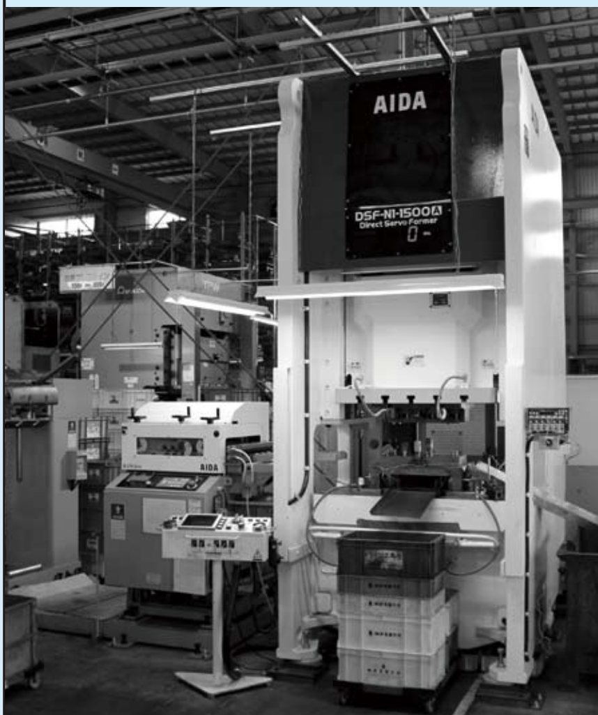
▲ダイレクトサーボプレスDSF-N1-A 150トン
