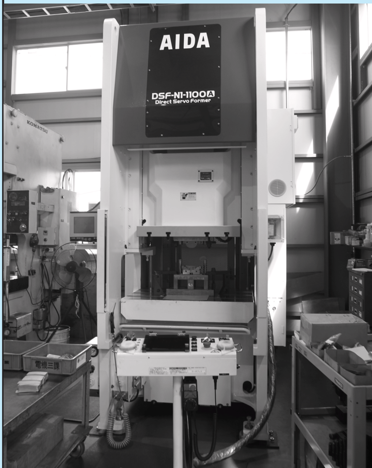
▲ 110トンサーボプレス機 ダイレクトサーボフォーマ「DSF-N1-1100A」
