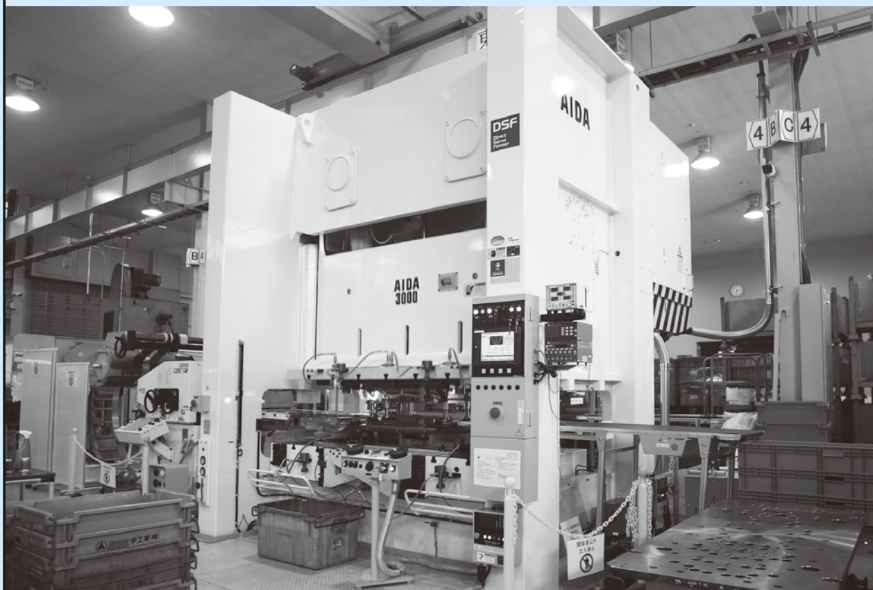
▲ダイレクトサーボフォーamer DSF-N2-3000 (300トン)
