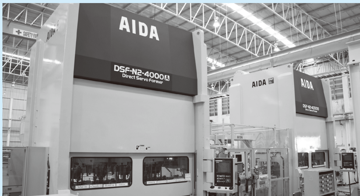
▲ タイ工場で稼働するダイレクトサーボフォーマー DSF-N2-4000A (400トン) 2台プレスライン
