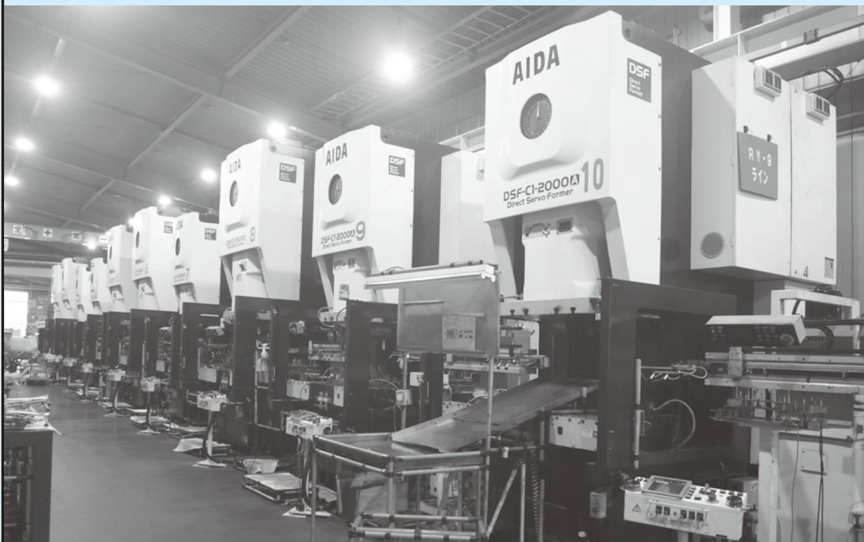
▲ ダイレクトサーボフォーマー DSF-C1-A 200トン、250トン10台口ボットライン
