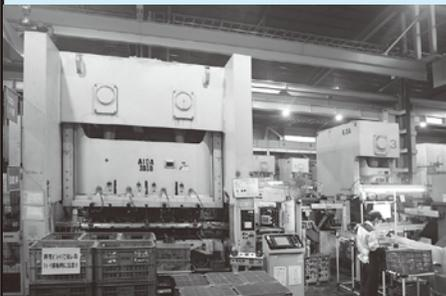
▲ 汎用機 300トン+150トン連結ロボット化
