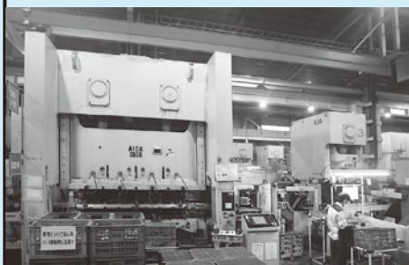
▲汎用機 300トン+150トン連結ロボット化
