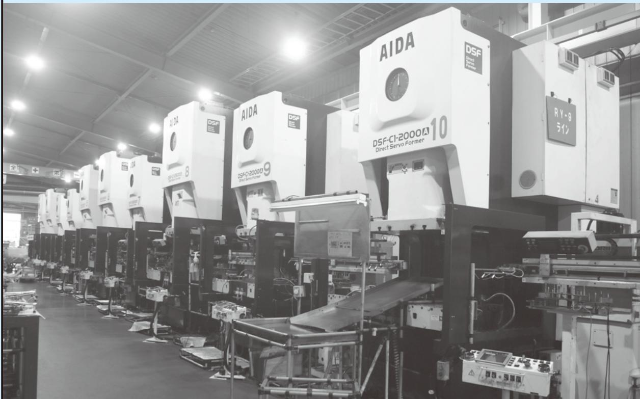
▲ダイレクトサーボフォーマー DSF-C1-A 200トン、250トン10台ロボットライン
