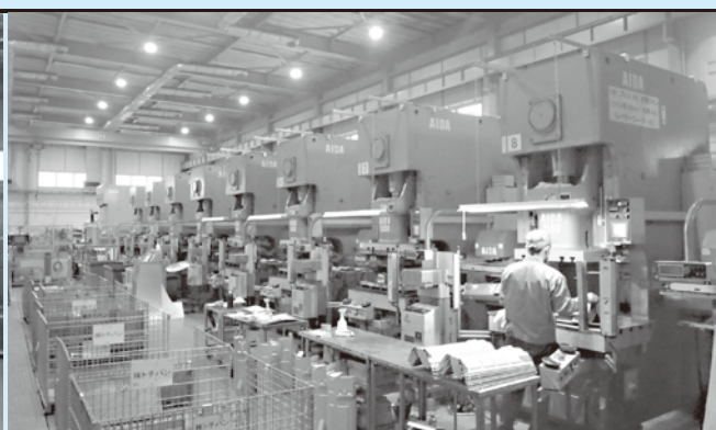
▲ NC1-150トン×8台 A-8 ロボットライン
