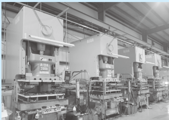
▲ NC1-200 トン ×4 台 A-8II ロボットライン
