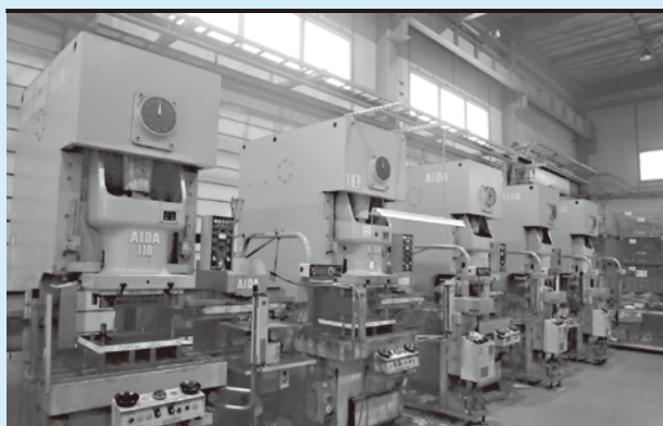
▲ NC1-110トン×5台 A-8II ロボットライン
