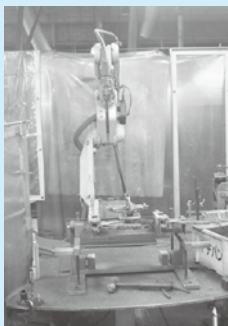
▲ ロボット溶接
