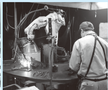
▲ 自動化ロボット溶接加工
