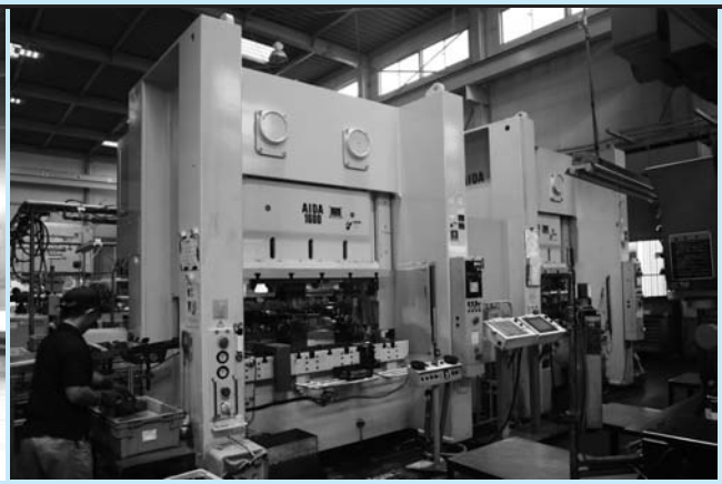
▲ 2 連式ロボット搬送プレス NS2-1600 (160 トン)
