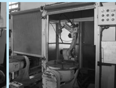
▲ フィラーロボット溶接装置
