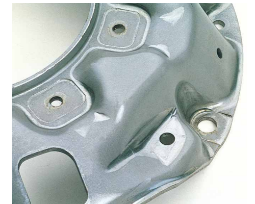
クラッチカバー Clutch Cover t : 3.0mm (SPHE)
