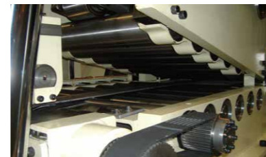
ワークロール口開き機構 Work Roll Access Feature
